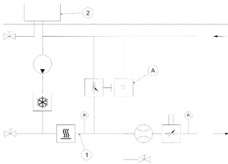
Fig. 6: Schéma hydraulique Integral IN 1850 MID 20
