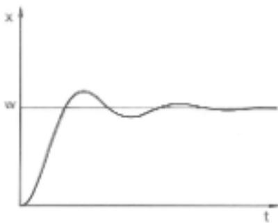
Fig. 54: Paramètres de réglage  $T_n$  et  $T_v$  trop petits
