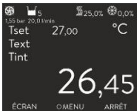
Fig. 45: Fenêtre de base Integral XT et Integral P avec régulation du débit
