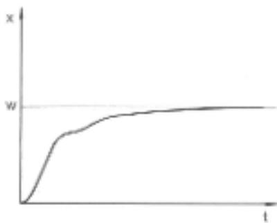
Fig. 55: Paramètres de réglage  $T_n$  et  $T_v$  trop grands
